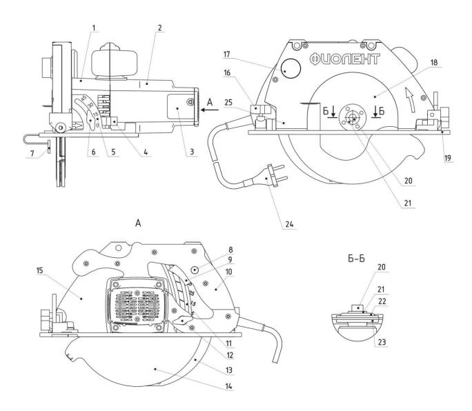
1 - редуктор; 2 - электродвигатель; 3 - крышка щетки; 4 - винт фиксации линейки; 5 - кронштейн с угловой шкалой; 6 - винт; 7 - линейка; 8 - кнопка блокировки включения; 9 - клавиша переключателя; 10 - рукоятка; 11 - шкала; 12 - винт; 13 - расклинивающий нож; 14 - кожух подвижный; 15 - кожух неподвижный; 16 - винт; 17 - патрубок; 18 - пильный диск; 19 - основание; 20 - винт зажимной; 21 - шайба; 22 - шайба фигурная; 23 - фланец пильного диска; 24 - шнур питания; 25 - крышка кожуха.
